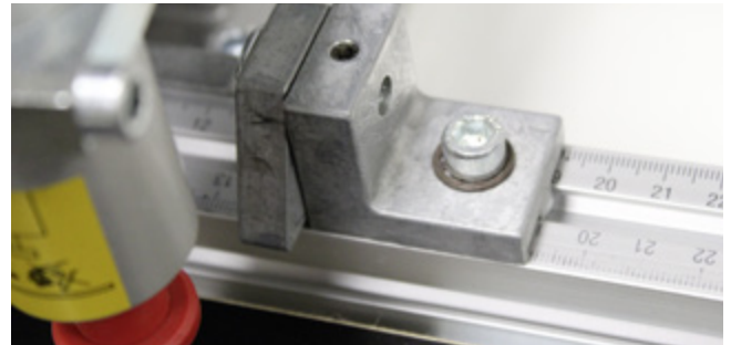
Abb. 32: Pendelanschlag mit Innensechskantschraube
