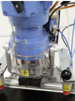
Abb. 36: Einpressmatrize für Scharniere
