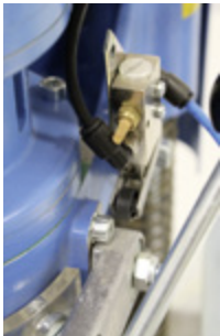
Abb. 20: Schwenkbügel mit Tastrolle
