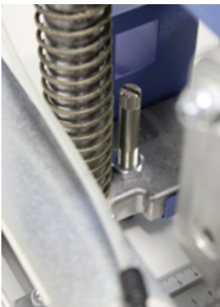
Abb. 30: Bohrtiefenanschlag mit Sechskantschraube
