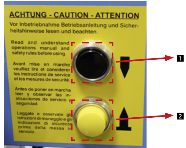
Abb. 37: Handventil und Tastschalter
