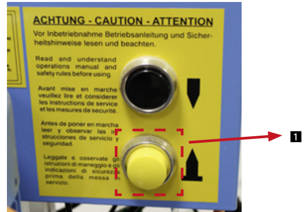
Abb. 27: gelbe Taste: Lösen der Niederhalter
