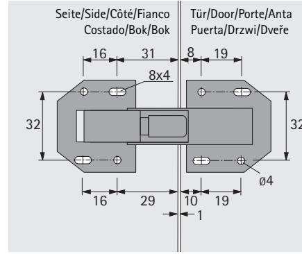
**D** Die Abbildungen zeigen Anschlag-Beispiele für 19 mm Wand- und Türstärken. Für schwächere Seiten- und Mittelwände, oder falls eine größere Fuge gewünscht wird, sind entsprechend mehrere Distanzplatten zu verwenden.
