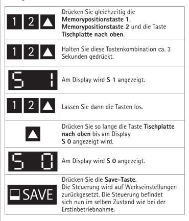
Um die Steuerung nach einer derartigen Änderung der Hubsäulenkonfiguration wieder verwenden zu können, gehen Sie wie folgt vor:
