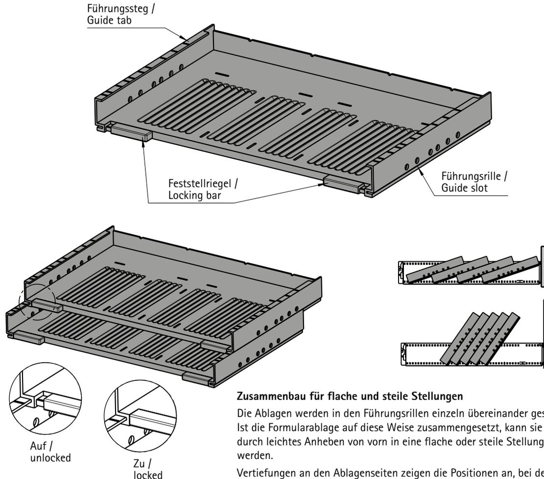
**Zusammenbau für flache und steile Stellungen**
